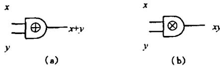
图 2 模 3 加和模 3 乘电路实现 (a) 模 3 加门 (b) 模 3 乘门
