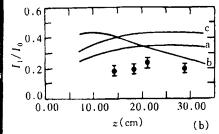
图 5 束流经过中间腔间隙后的基波调制 (a) 调制电流波形 (z=21cm,No.458) (b) 调制电流随纵向距离的变化实线 (a,b,c 和点的含义同图 4)
