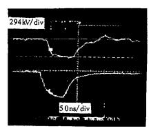
图 3 电子束波形 (上: 电压, 下: 束流, No.67)
