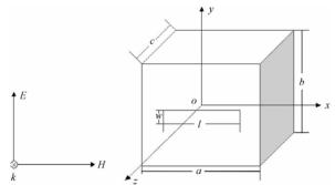
图 1 屏蔽腔结构及入射场方向示意图
