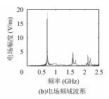
图 4 l=140mm, (0,0,0)处电场时域和频域波形 低模的频率为 0.707GHz,而 l=140mm 时,最低模的频率变为 0.697GHz。
