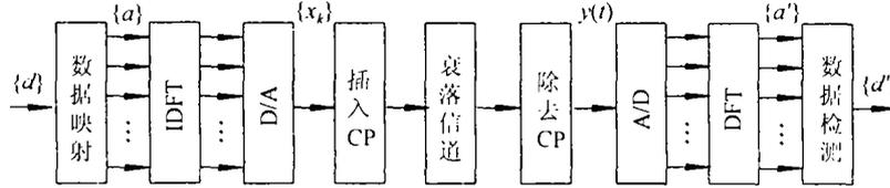
图 1 OFDM 系统原理框图
