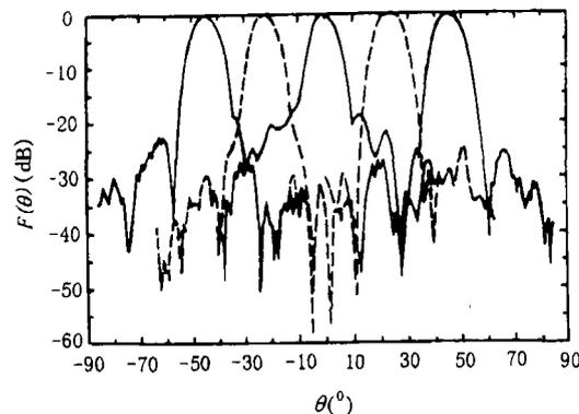
图 2  $f = 2.2\text{GHz}$  天线 5 个波束的测试方向图
