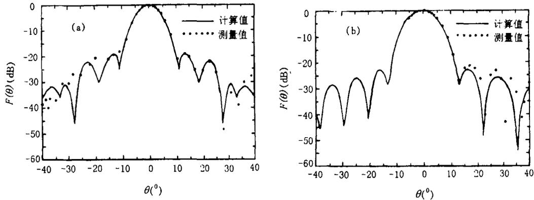
图 3  $f = 2.2\text{GHz}$  天线中心波束的理论计算方向图和测试方向图
