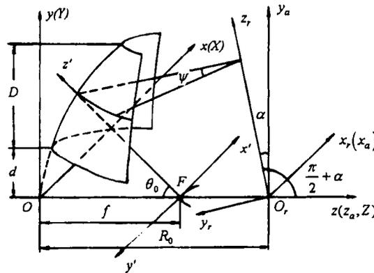
图 1 抛物环面天线的几何示意图
