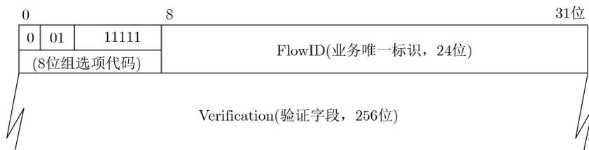
图2 密码标识结构图
