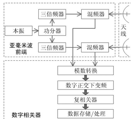
图 2 THz 干涉仪系统结构框图
