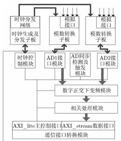
图3 太赫兹干涉仪相关器结构框图
